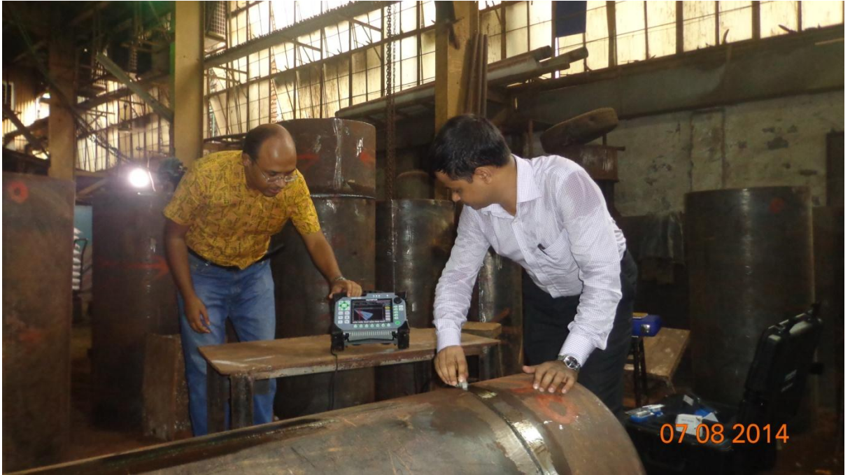
বয়লার প্রস্তুতকালীন সময়ে এনডিটি (NDT) পরীক্ষণ এর ফটোগ্রাফ
